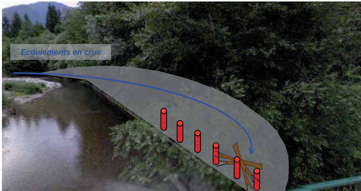
Schéma de principe de l'aménagement d'un piège à flottants
