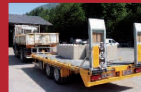
Remorque plateau, transport engins et matériaux, charge utile 8 tonnes.
